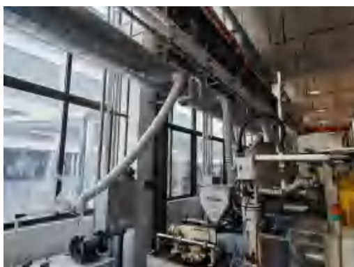
每台注塑机都有配套的废气集气管
