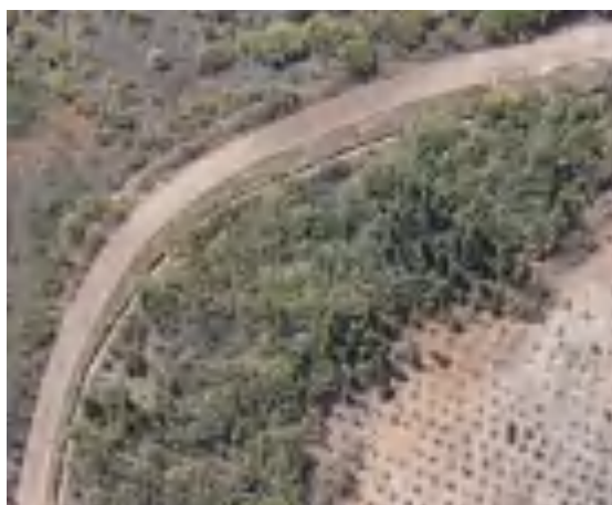
截（排）水沟（航拍）
