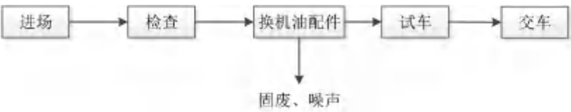
图 2-2 保养工艺流程及产污环节
