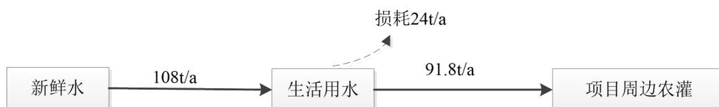
图 2-1 项目水量平衡图 t/a
