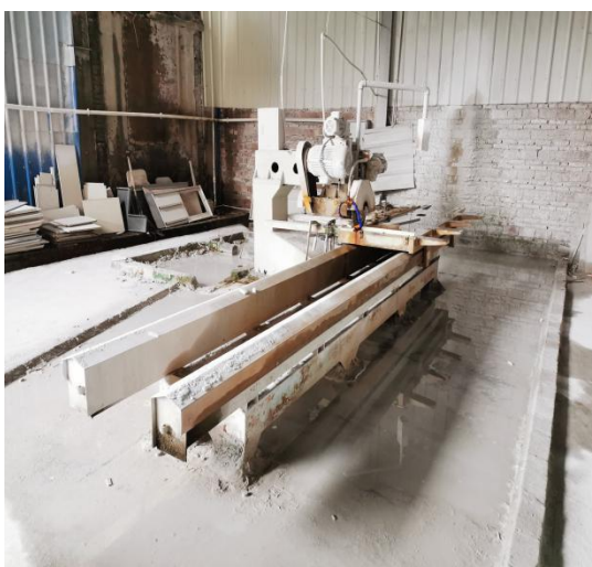
图 3-5 自带水喷淋设备
